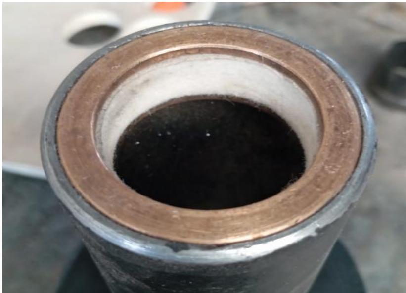
Figura 30: Montaje de fieltro.
