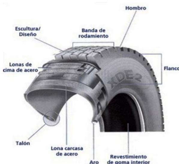
*Ilustración 6: Componentes de los neumáticos*
