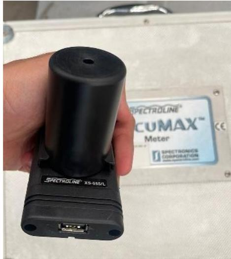
*Figura 8 Detector de sensor de luminancia AccuMAX XS-555/L.*
