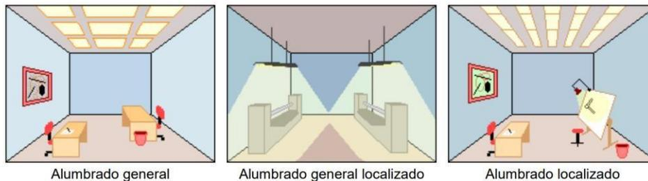
*Figura 12 Métodos de alumbrado*
