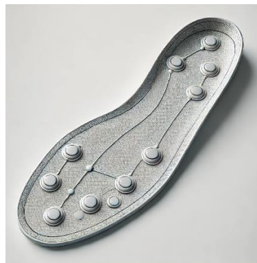
Figura 6. Plantilla con 10 sensores.
