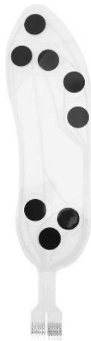
Figura 5. Plantilla con 8 sensores [91].
