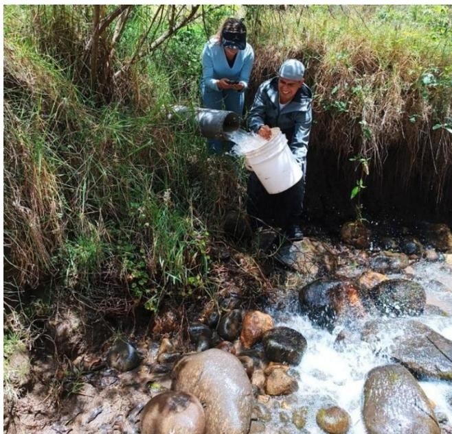
*Nota.* Aforo realizado en la tubería de desagüe del desarenador.
