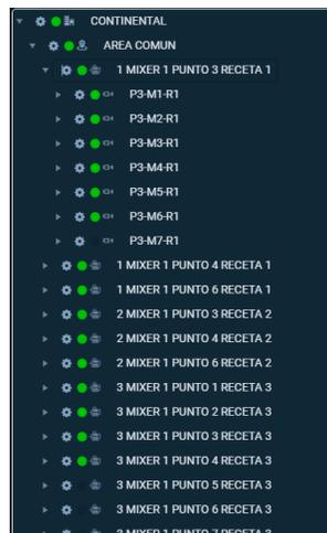
**Nota:** La figura muestra la estructura jerárquica del directorio en la plataforma EI Analytic, diseñada para organizar las mediciones de forma estructurada.
