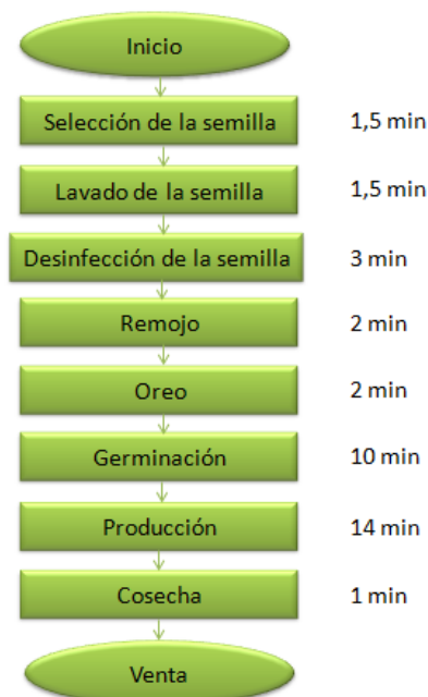
Grafico 34. Proceso de producción de un kilo de forraje verde hidropónico de cebada
