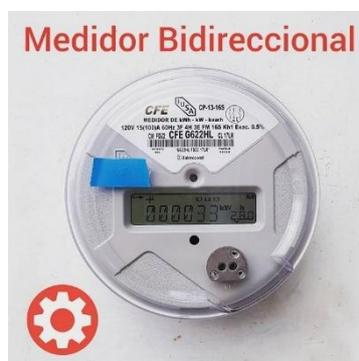
**Figura 9.** Medidor bidireccional
