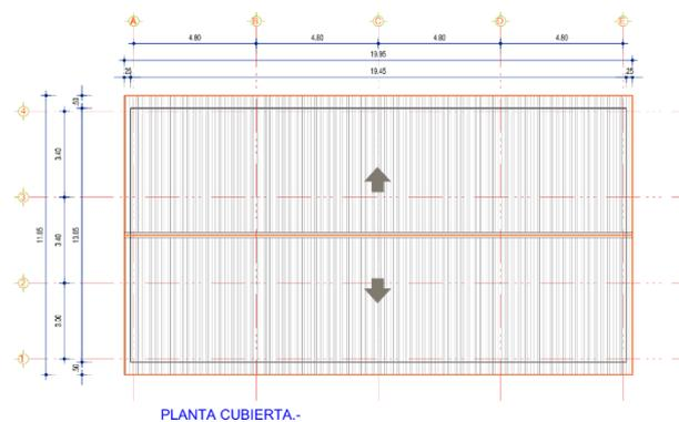
**Figura 20.** Dimensionamiento del tejado.
