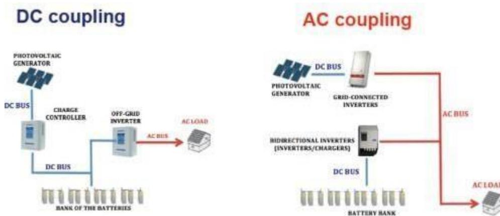
IMAGEN 27: Comparación entre configuración CC y AC
