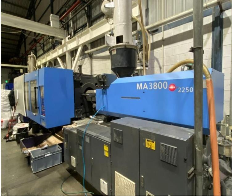
**Figura 20:** Maquina Inyectora
