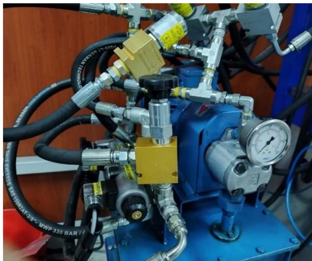
Figura 13. Válvula solenoide instalada en la prensa hidráulica
