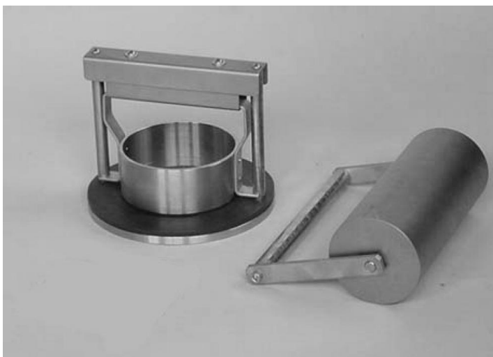
Figura 11. Equipo para determinar COOB
