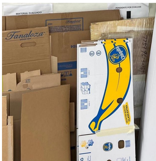
Figura 16. Láminas rechazadas por humedad alta
