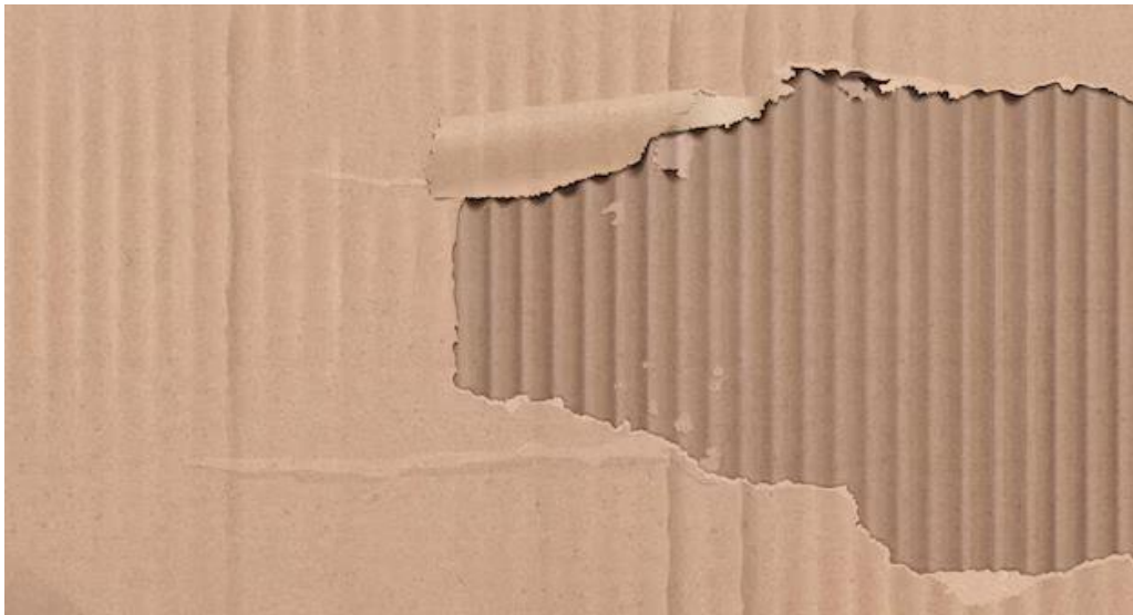
Figura 17. Lámina con delaminado alto
