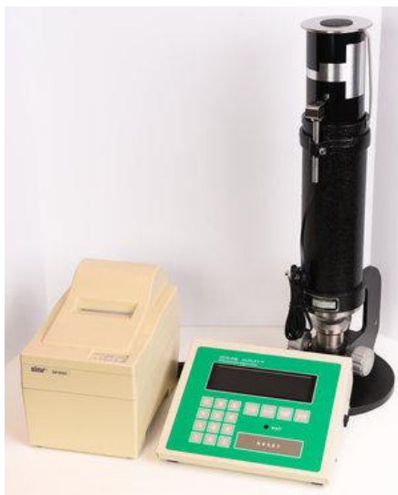
Figura 13. Densímetro para determinar la porosidad por Gurley
