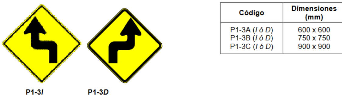
Figura 19 Señalización Curva y Contracurva cerrada
