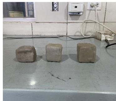
Figura 7 Ensayo de densidad natural empleando cera de parafina
