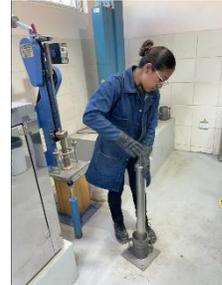
Figura 14 Elaboración de ensayo Proctor modificado
