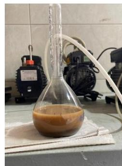
Figura 8 Determinación de la gravedad específica
