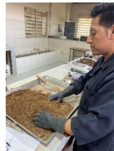
Figura 15 Homogenización de suelo para elaboración de especímenes
