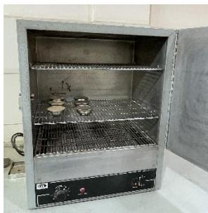
Figura 6 Ensayo de contenido de humedad en las muestras de suelo
