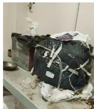
Figura 5 Almacenamiento en laboratorio de muestras inalteradas.
