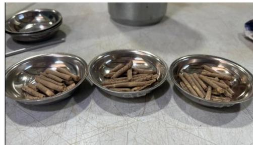
Figura 10 Elaboración de rollos para determinar límite plástico
