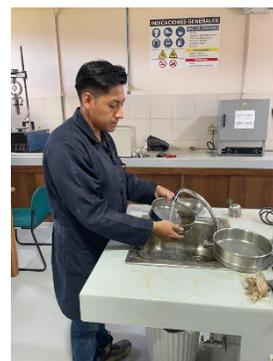
Figura 11 Ensayo de granulometría por lavado
