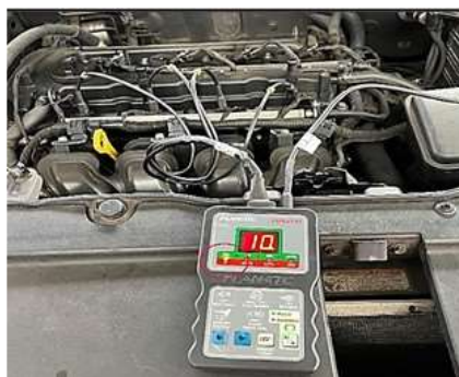
Figura 4.2: Ancho de pulso de 10 milisegundos en prueba automática
