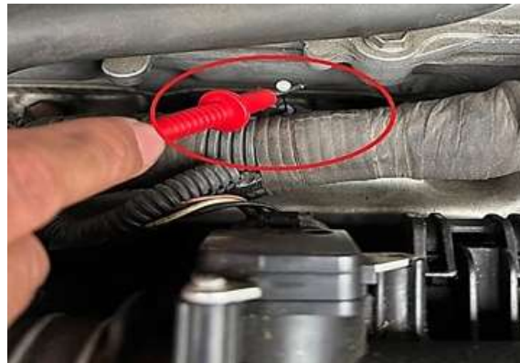
Figura 1.12: Punta de medición en el cable de señal de inyector
