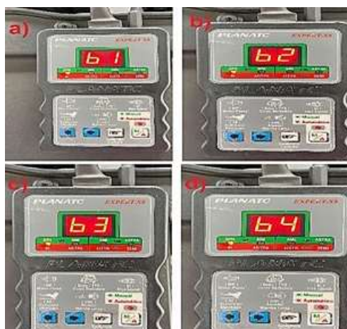
Figura 4.8: Activación de los solenoides de inyectores
