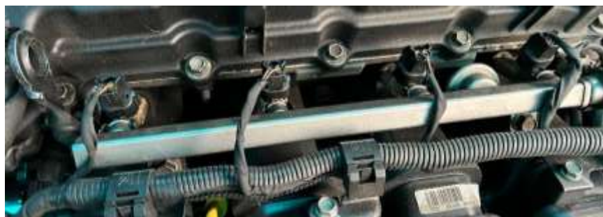
Figura 2.1: Ubicación de inyectores Tucson Ix
