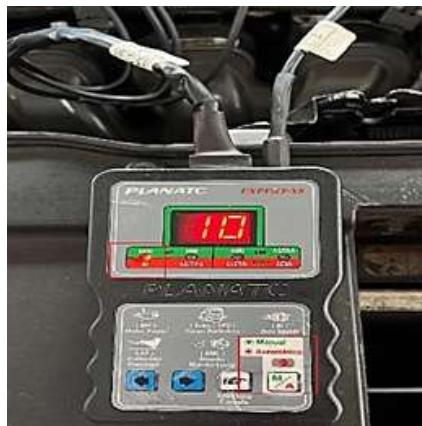
Figura 4.7: Tiempo de activación automática de 10 milisegundos
