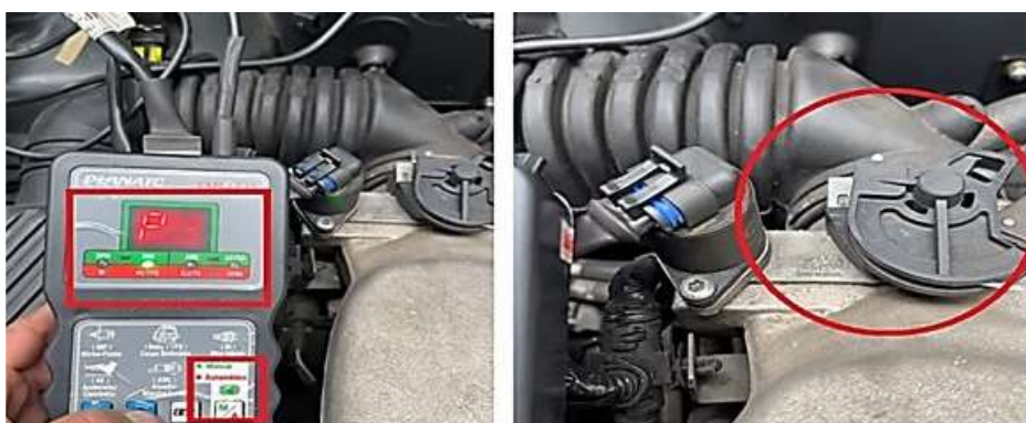
Figura 4.6: Calibración de la válvula IAC
