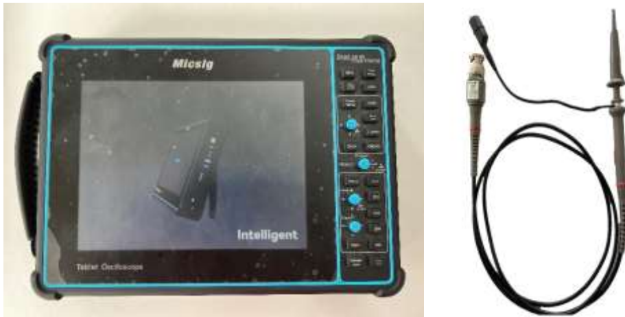
Figura 1.14: Equipo de diagnóstico con puntas de prueba
