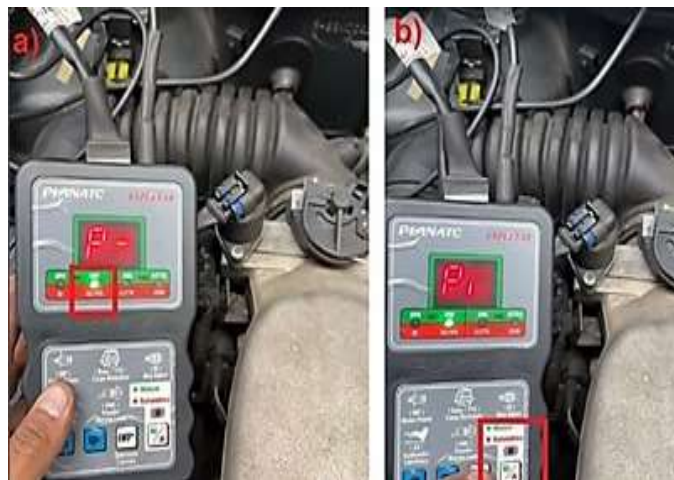
Figura 4.4: Activación de válvula IAC con pulso automático
