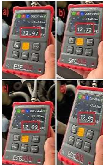
Figura 4.14: Diagnóstico de bobinas COP a 1000 rpm.
