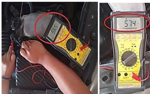
Figura 2.13: Medición de resistencia en ohmios
