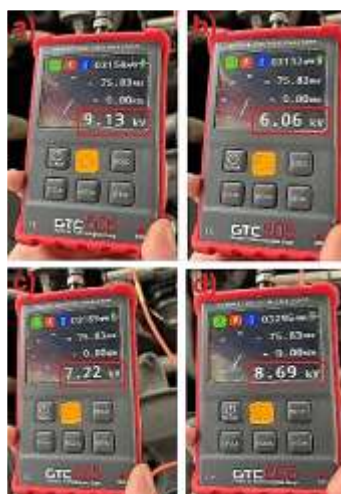
Figura 4.17: Diagnóstico de bobinas COP a 3500 rpm.
