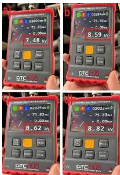
Figura 4.16: Diagnóstico de bobinas COP a 3000 rpm.
