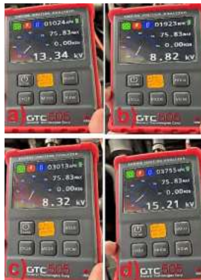
Figura 4.19: Diagnóstico de Bobina independiente
