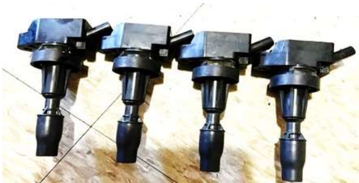
Figura 3.11: Bobinas COP de 2 cables, Tucson IX
