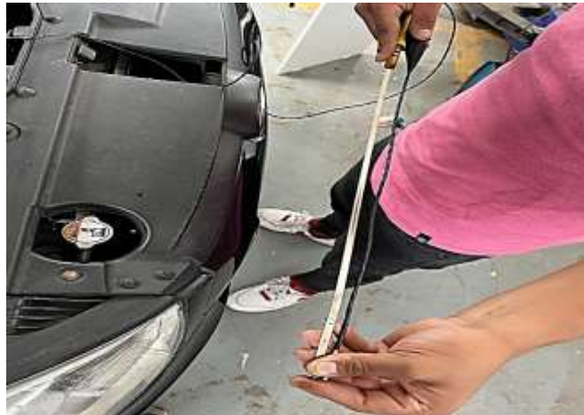
Figura 1.28: Colocación de sonda de temperatura.
