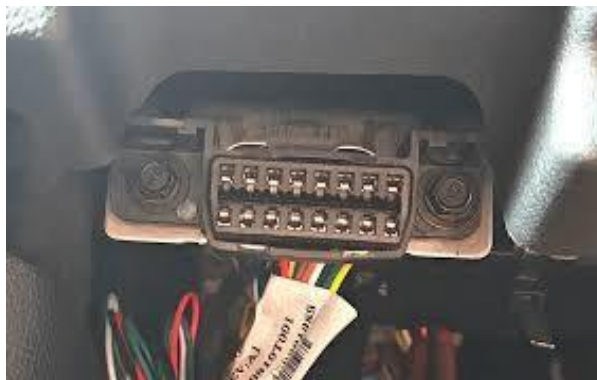
Adquisición de datos mediante entrada OBD II
