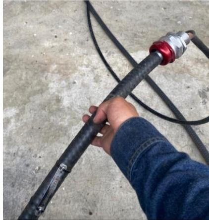
**Figura 81.** Cable armado.
