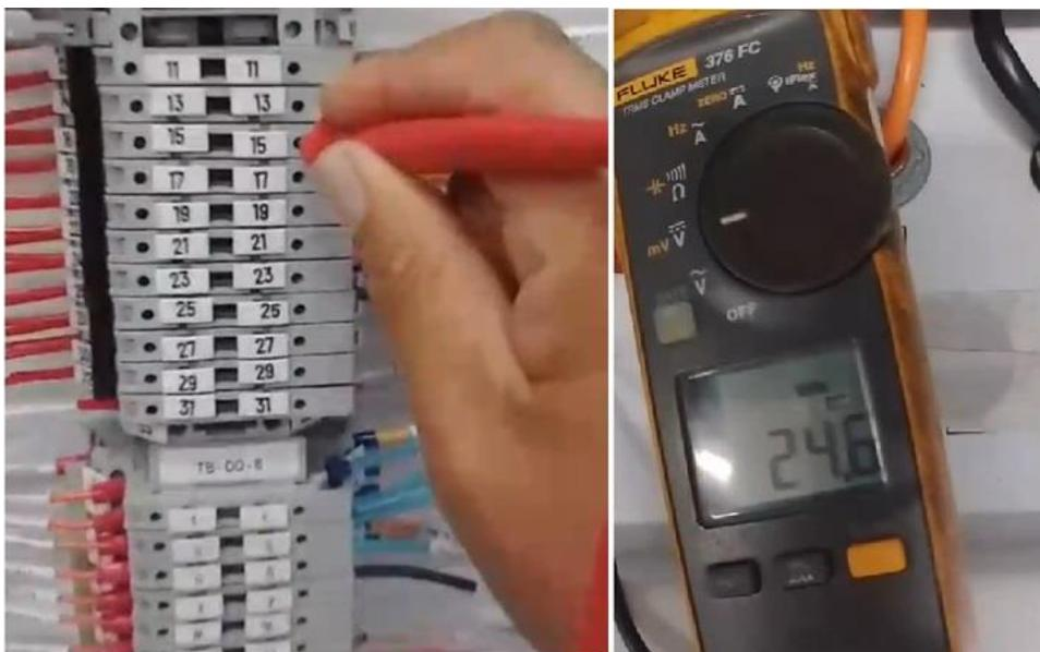
**Figura 112.** Pruebas de voltaje en borneras.
