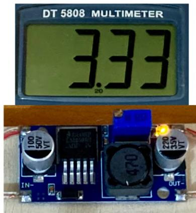
**Figura 4-2.:** Medición de voltaje para el regulador configurado a 3.3V. Elaboración propia basada en los conceptos de [21, 32].
