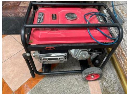
**Ilustración 66:** Vista 2 de FFR generador 6500 Watts
