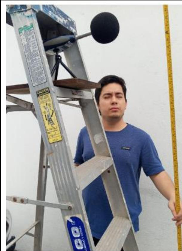
**Ilustración 77:** Ajuste de posición de sonómetro Elicrom 308
