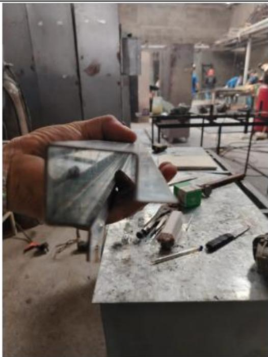
**Ilustración 53:** Material plancha galvanizado espesor 1.5mm
