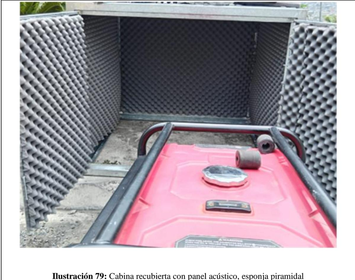
**Ilustración 79:** Cabina recubierta con panel acústico, esponja piramidal
