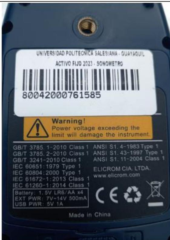
**Ilustración 75:** Características técnicas del sonómetro Elicrom 308
