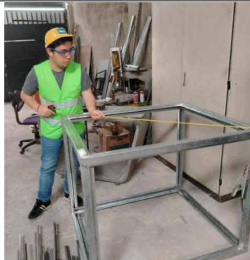
**Ilustración 60:**Verificación de ubicación a escuadra de los parantes de la estructura metálica de la cabina
