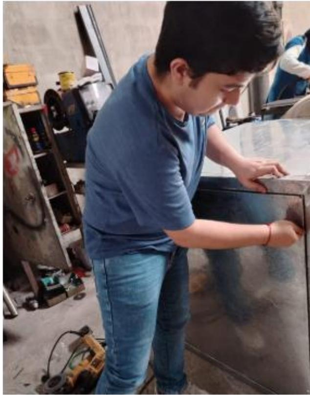
**Ilustración 82:** Ajuste de paneles en estructura metálica de cabina
