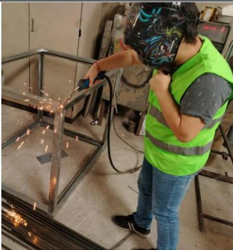
**Ilustración 59:** Proceso de remate en puntos de suelda
