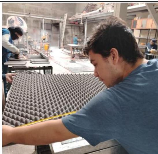
**Ilustración 74:** Medición de panel acústico esponja piramidal
