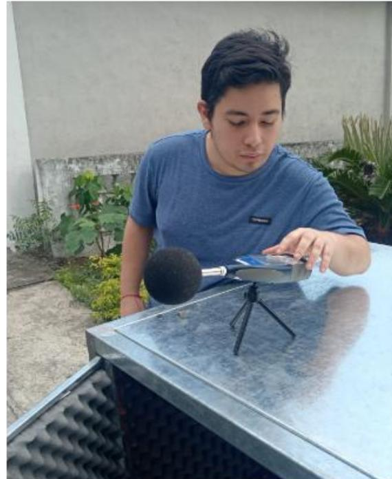
**Ilustración 78:** Ajuste de parámetros sonómetro Elicrom 308
