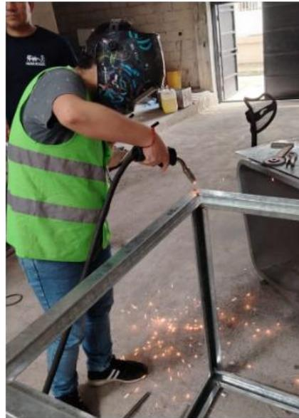
**Ilustración 58:**Proceso de soldado de esquina frontal izquierda de estructura metálica de cabina
