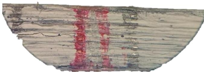
**Figura 25.** Marcando del alcance de la pre-grieta mediante observación óptica.
