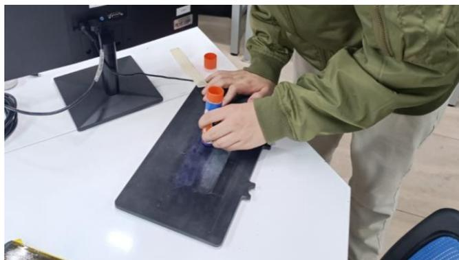
**Figura 8.** Aplicación de la capa homogénea de pegamento sólido en barra.
