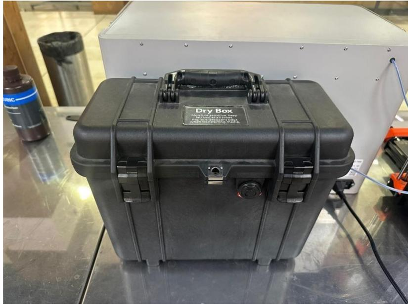
**Figura 17.** Dry Box con bolsas desecantes para capturar humedad.
