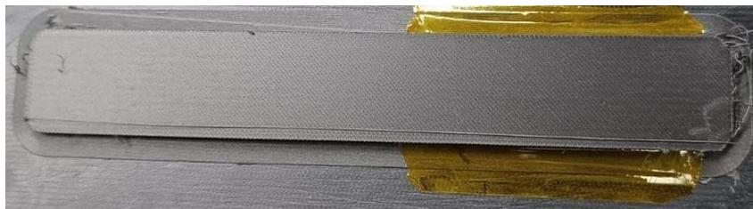
**Figura 7.** Probeta de ajuste de parámetros en Onix™.
