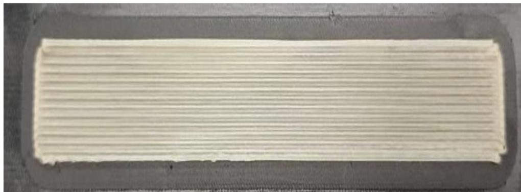
**Figura 12.** Primeras capas de fibra de vidrio
