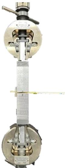
**Figura 23.** Ensayo de pre-fractura a apertura controlado.
