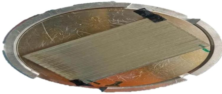
**10.13.** Probeta colocada en la base del SEM
