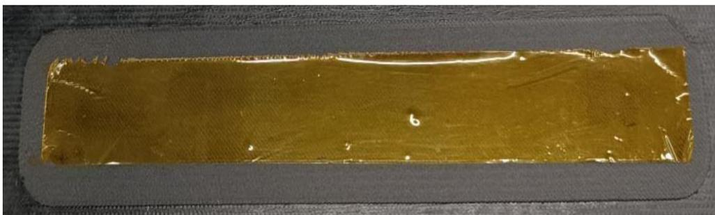
**Figura 10.** Colocación de la capa de cinta térmica entre los dos constituyentes.
