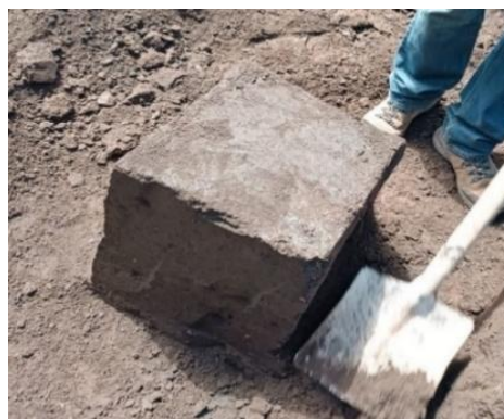
Figura 15. Extracción de la muestra de suelo.
