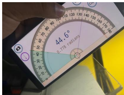
Figura 58. Medición con graduador a 45 grados para una lámina de 5 mm.
