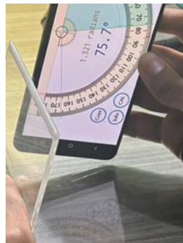
Figura 55. Medición con graduador a 75 grados para una lámina de 3 mm.
