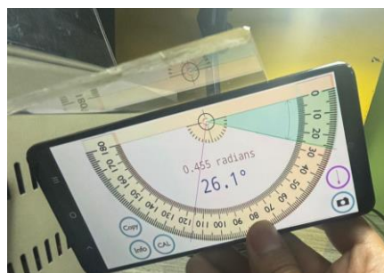
Figura 53. Medición con graduador a 25 grados para una lámina de 3 mm.
