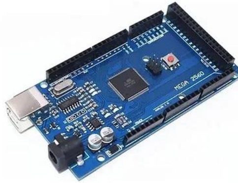
Figura 26. Arduino Mega 2560 R3 [50].
