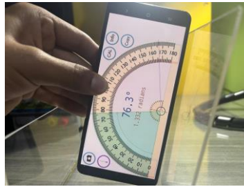
Figura 51. Medición con graduador a 75 grados para una lámina de 2 mm.
