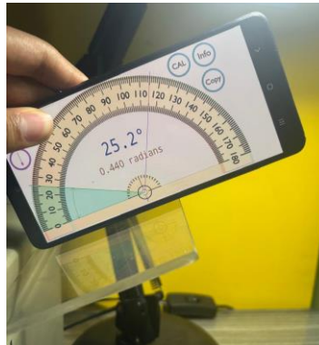
Figura 57. Medición con graduador a 25 grados para una lámina de 5 mm.
