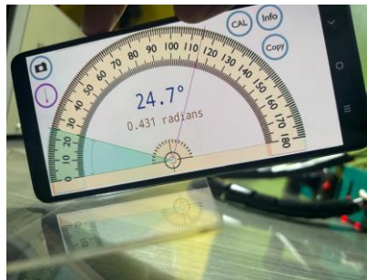
Figura 49. Medición con graduador a 25 grados para una lámina de 2 mm.
