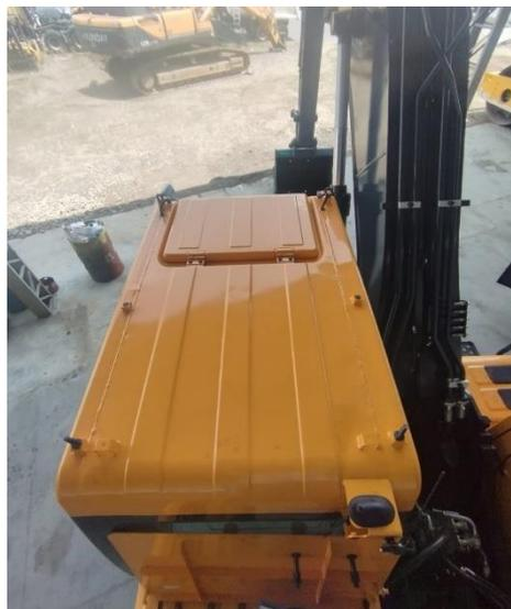
6 puntos de anclaje para la estructura FOPS en el techo de cabina de excavadora.
