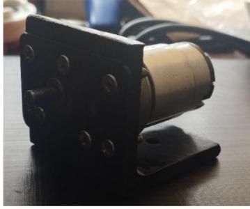
Motor con escobillas y caja reductora, Garcés
