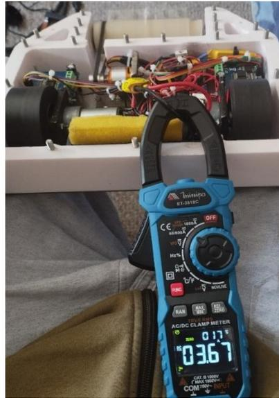
Medición de la corriente en “vacío”, Garcés
