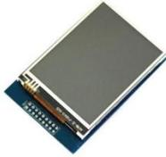
Pantalla LCD TFT De 2.8 Conectado al Arduino, permite la interacción entre el operador y el sistema de extracción. Interacción entre el operador y el proceso. [25]
