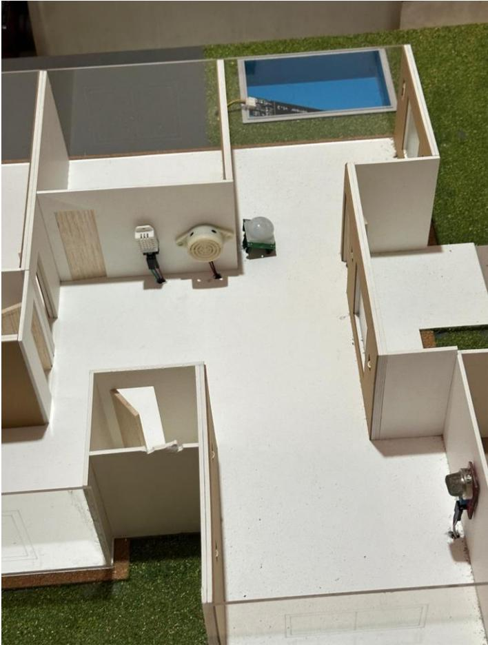
Figura 35 Montaje de sensores y buzzer
