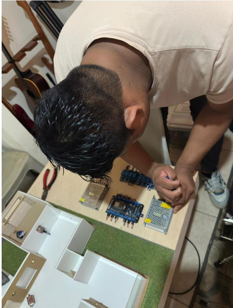
Figura 24 Montaje de fuentes de poder
