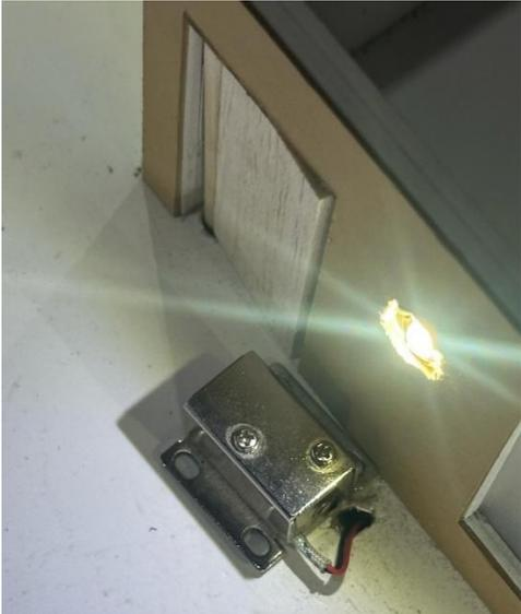
Figura 40 Cerradura eléctrica activada desde la pantalla HMI
