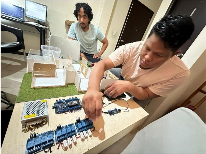
Figura 30 Montaje de relés
