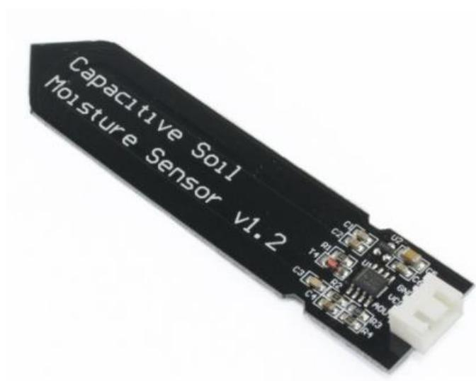
Figura 5 Sensor de humedad de suelo capacitivo
