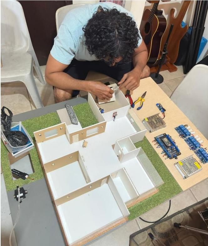
Figura 26 Montaje motor en puerta garaje
