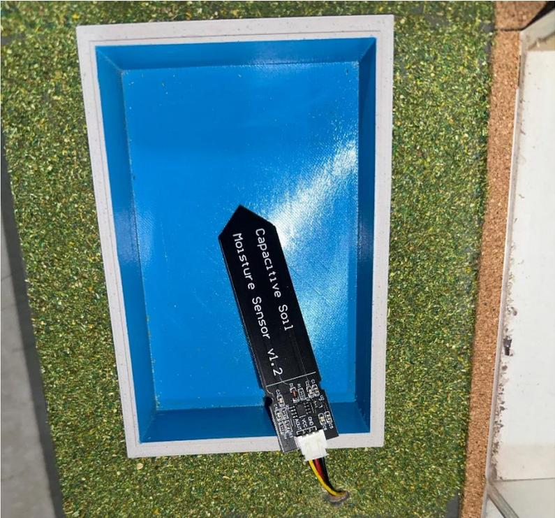
Figura 33 Sensor de humedad de suelo
