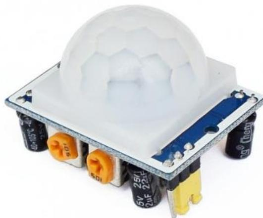
Figura 6 Sensor de movimiento PIR HC-SR501
