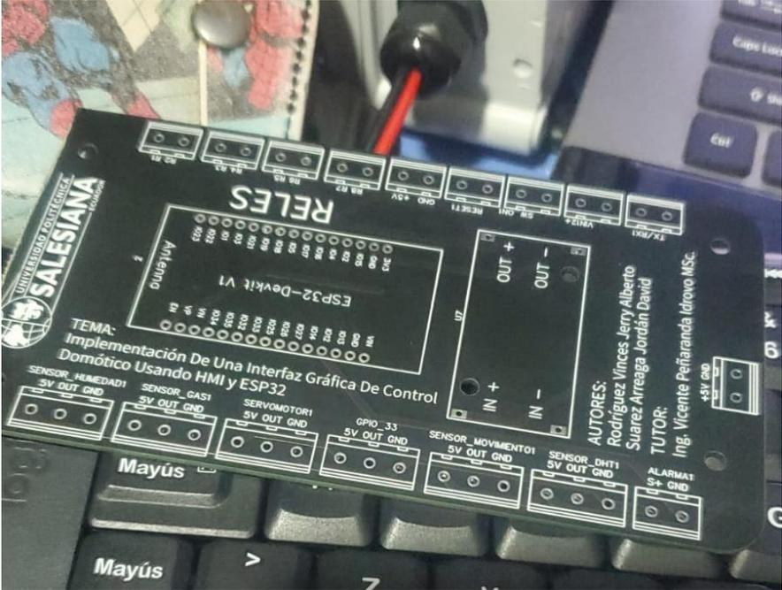
Figura 18 Placa PCB de prototipo
