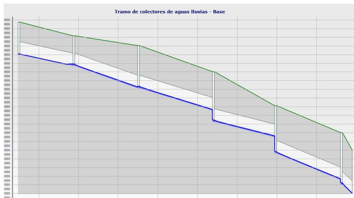
*Nota.* Perfil que muestra el comportamiento del flujo a lo largo de la sección que va desde el pozo “E1” hasta “V4”. Elaborado por: El autor a través del programa SewerGEMS, 2024.
