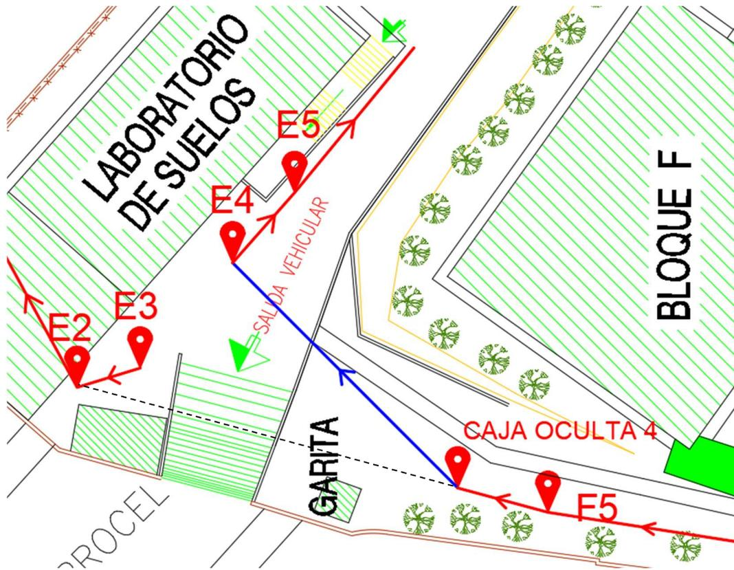
*Nota.* La línea de color azul representa la sección de tubería reconectada desde “CAJA OCULTA 4” hacia la caja “E4”, las líneas rojas representan tuberías que no han sido modificadas, la línea punteada de color negro muestra la anterior conexión y las flechas indican el sentido de flujo. Elaborado por: El autor a través del programa Civil 3D, 2024.
