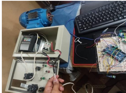
Figura 54. Conexiones a los botones y leds.
