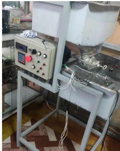
Figura 58. Implementación final de la caja de control.
