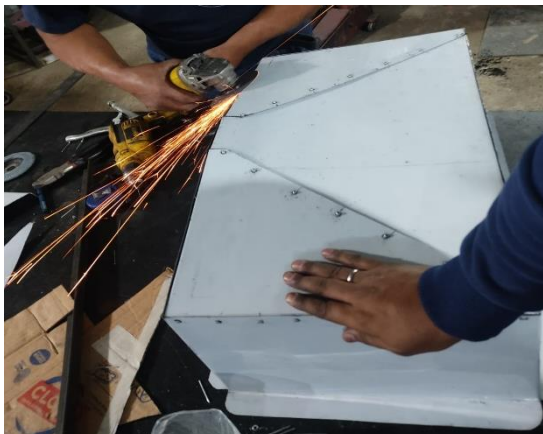
Figura 47. Remachado de las tolvas.
