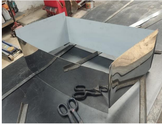
Figura 46. Corte y dimensionamiento de las tolvas.
