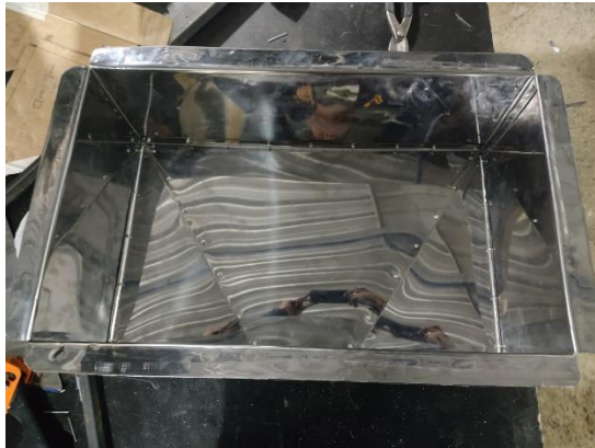
Figura 46. Corte y dimensionamiento de las tolvas.
