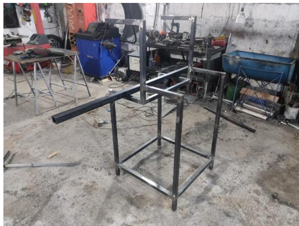
Figura 44. soldadura de la estructura.
