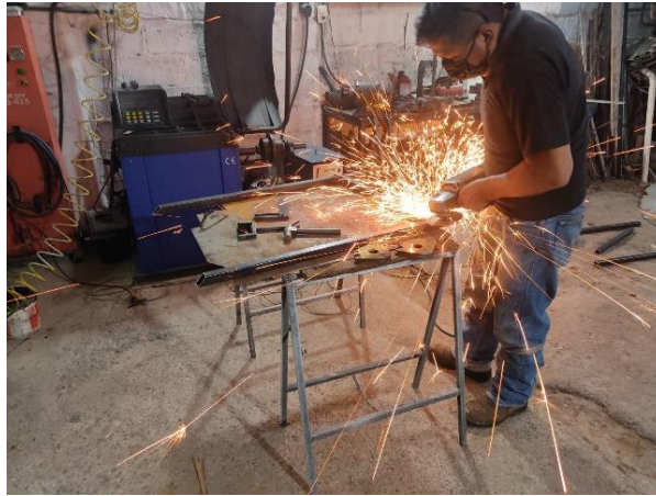
Figura 43. Corte y dimensionamiento de la estructura.
