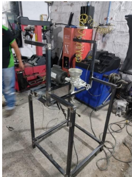
Figura 50. Estructura con el molino y motor.
