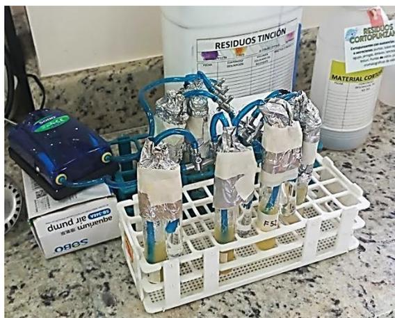
*Figura 8 Modelo de biorreactor tipo Batch*
