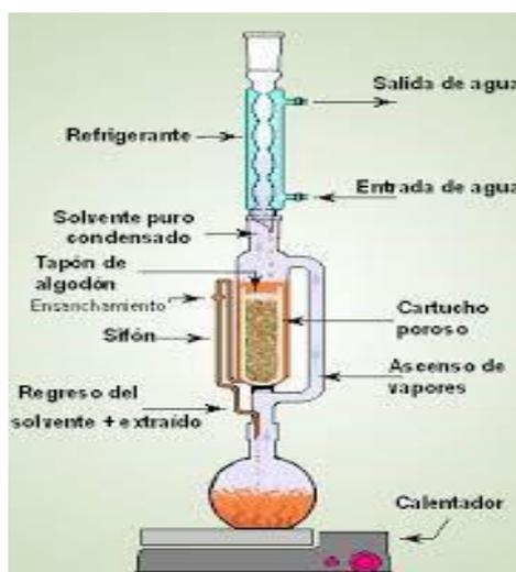
**Ilustración 7** Extracción Soxhlet
