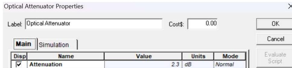
Figura 2.29: Parámetros del Atenuador XGS-PON.
