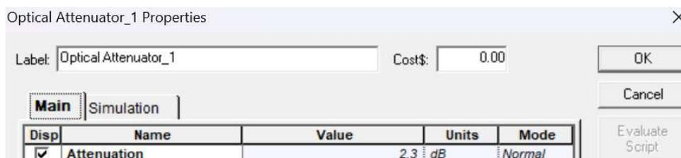
Figura 2.16: Parámetros del Atenuador GEPON.
