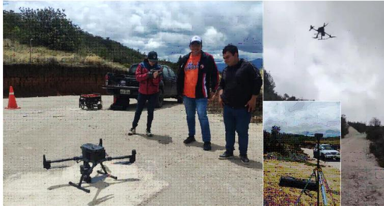
*Fuente: Propia, realización levantamiento con el Dron Matrice 350 RTK ,2024*
