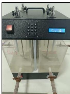
Figura 1. Fotografía de la prueba de jarras a diferentes concentraciones de coagulante.
