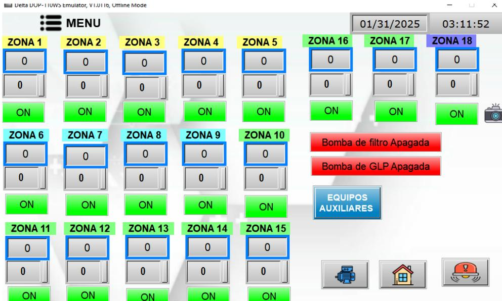
Vista general de interface de zonas de Temperatura de máquinas de termoformado.
