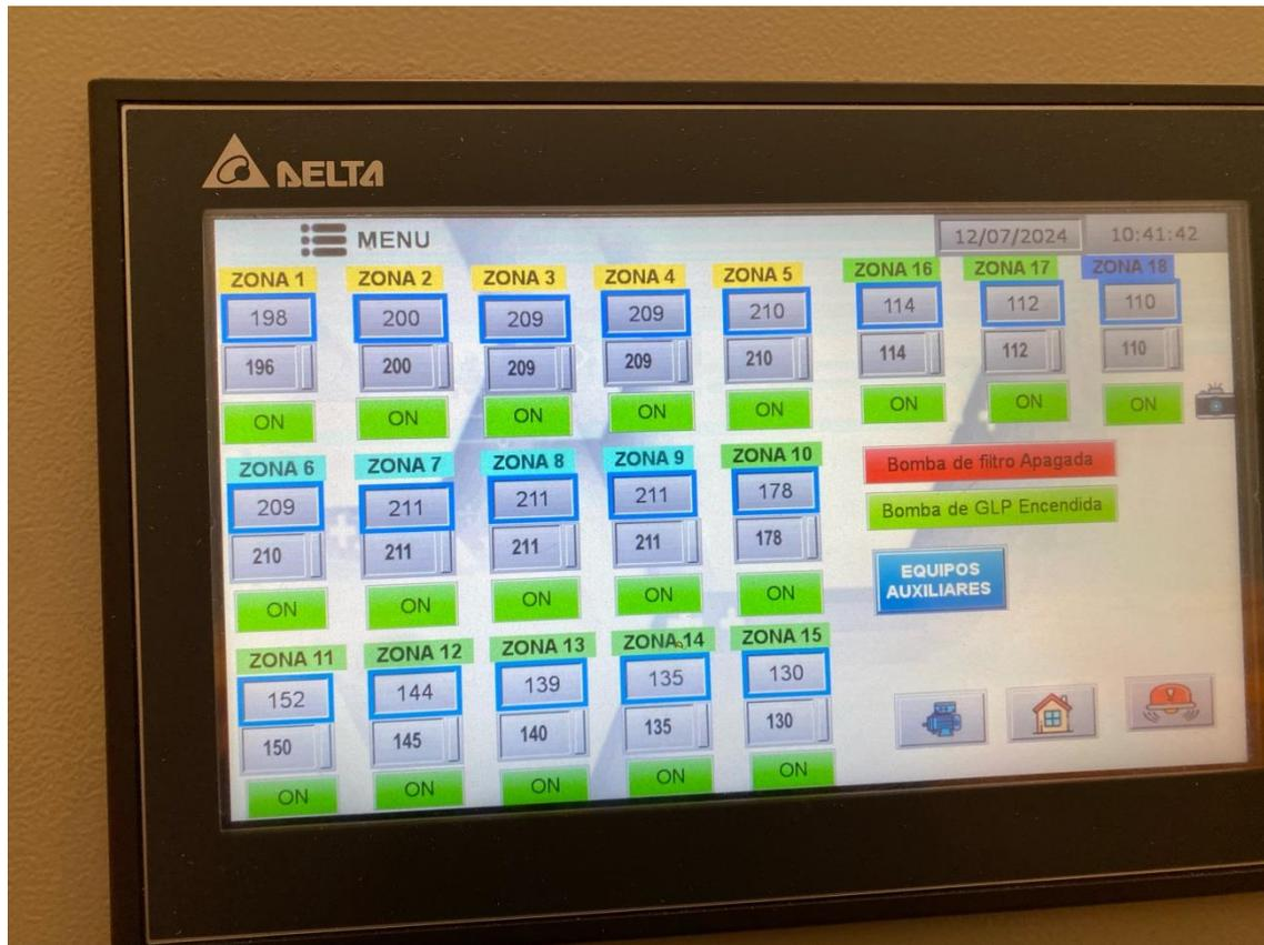
Vista general de interface de zonas de calentamiento de máquinas de termoformado.
