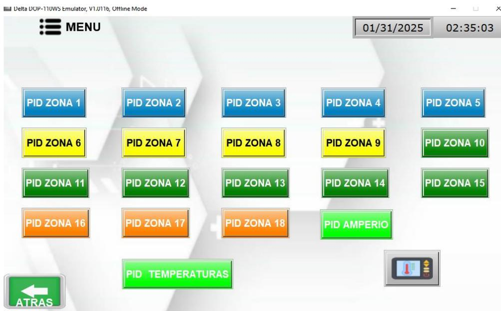
Vista general de interface de selección de zonas de configuración PID de máquinas de termoformado. Realizado por: Cristian Aña
