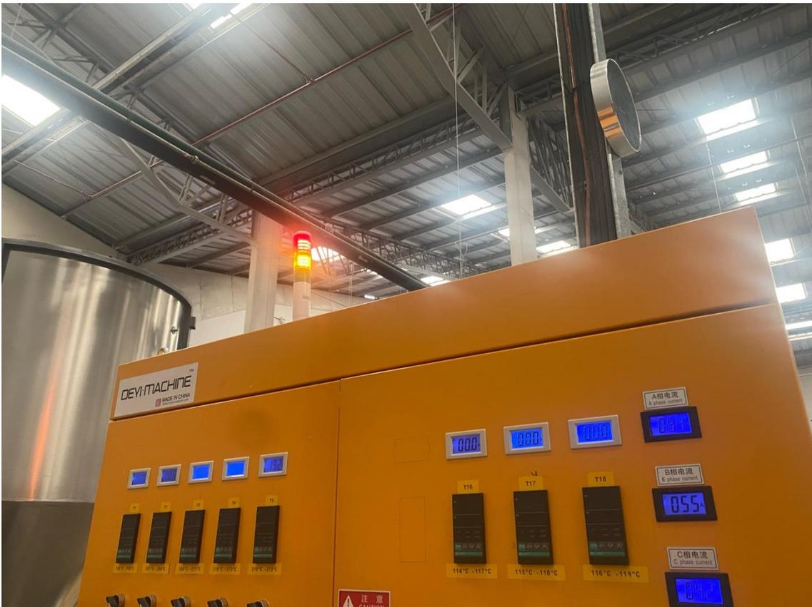
Vista general de activación de baliza led en estado rojo por alta temperatura en zona de calentamiento. Realizado por: Cristian Aiña
