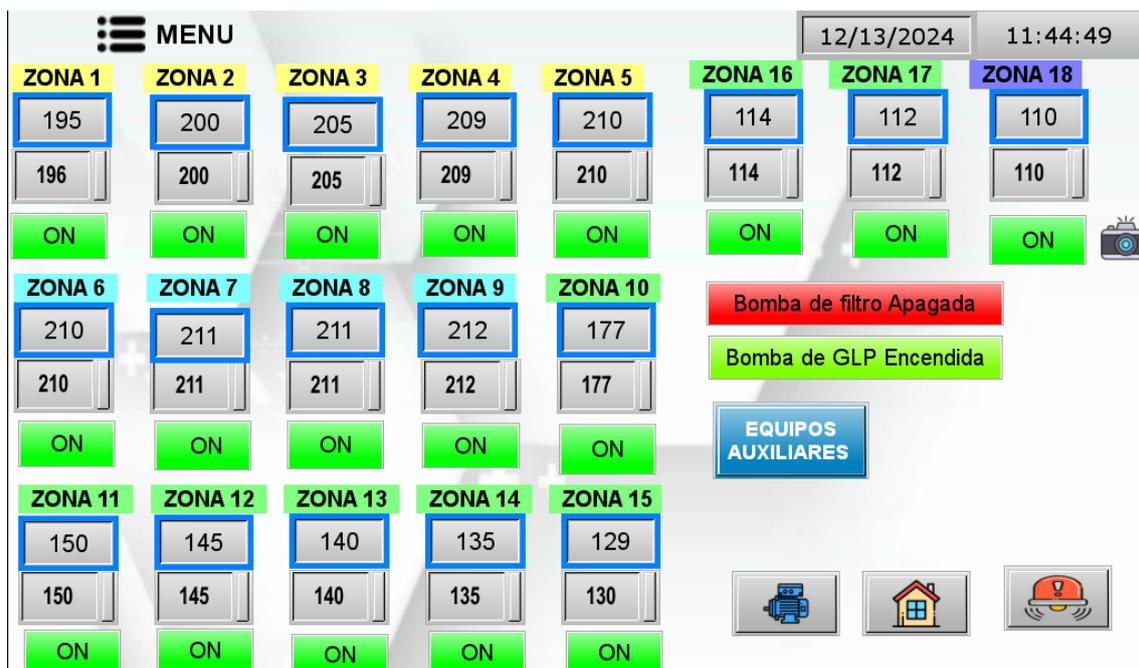
Vista general de interface de Zonas de Temperaturas de máquinas de termoformado.
