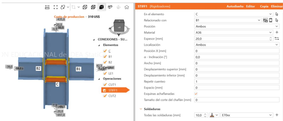
**Figura 29.** Aplicación rigidizadores IDEA Statica [24]
