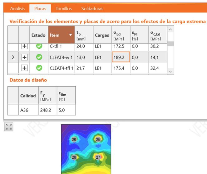
**Figura 42.** Verificación de placas IDEA Statica[24].
