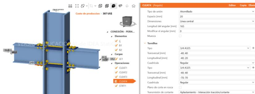
**Figura 38.** Placas T colocadas en la conexión IDEA Statica [24].
