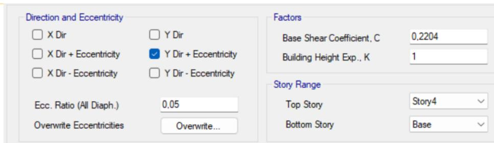
Figura 19. Configuraciones del sismo estático en dirección Y,  $E_y$  estático.
