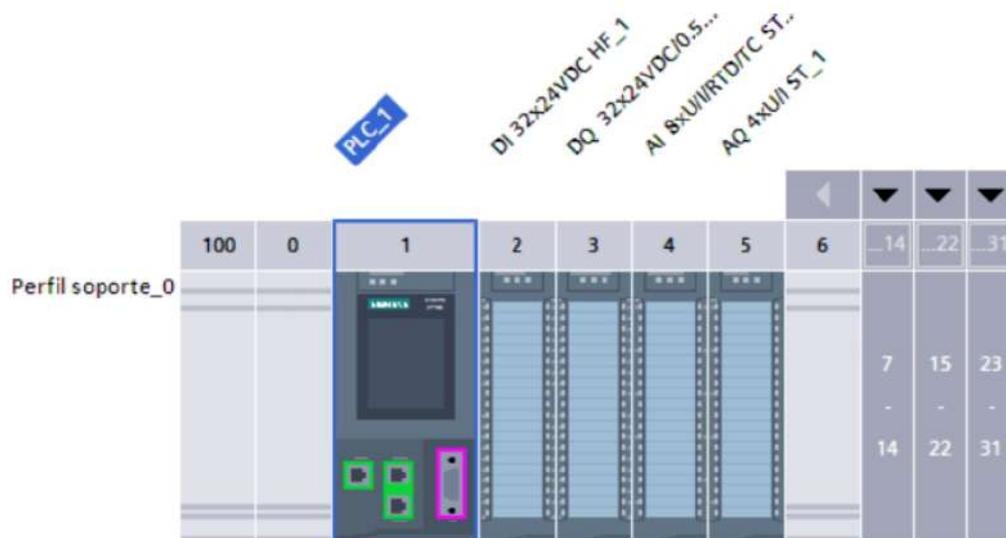
La disposición de los módulos de entrada y salida conectados al PLC S7-1500, donde se puede visualizar los diferentes módulos configurados con sus respectivas direcciones, permitiendo una integración completa dentro del entorno de automatización.
