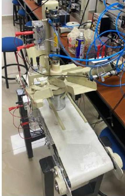
Esta planta incluye un transportador motorizado encargado de desplazar los envases a través de las diferentes etapas del proceso. Los sensores instalados detectan la posición del envase y envían señales al controlador lógico programable (PLC), activando válvulas y actuadores neumáticos en los momentos precisos. Estas acciones permiten la colocación y ajuste de la tapa en el envase de manera automatizada y sincronizada.
