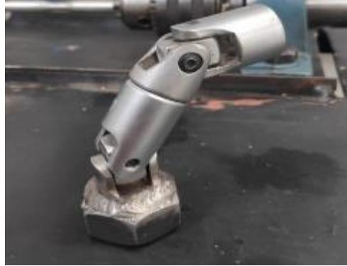
**Figura 37.** Cardan soldado a una tuerca de 1 pulgada, el dispositivo se realizó a partir de 2 acoples universales de mando de media pulgada.
