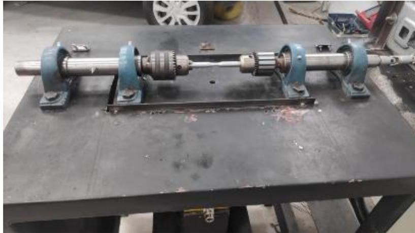
**Figura 57.** Sujeción de la probeta en los mandriles y verificación que las conexiones
