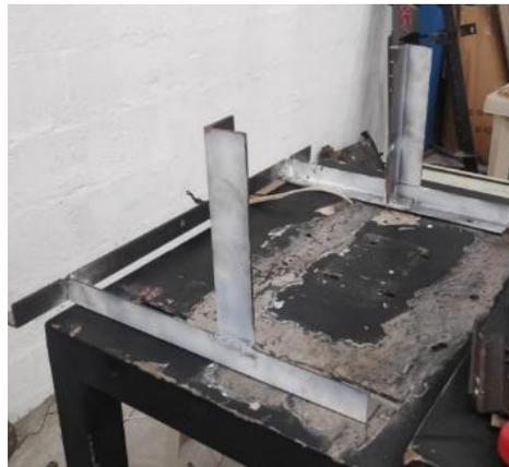
**Figura 36.** Estructura para anclar el soporte de transmisión de la maquina soldada con electrodo 6011 marca AGA.
