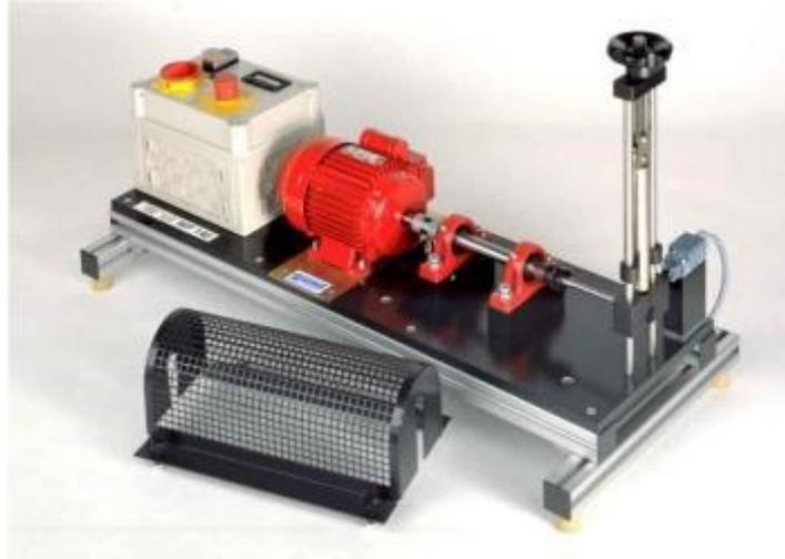
**Figura 7.** Dispositivo de viga rotativa en voladizo [1]
