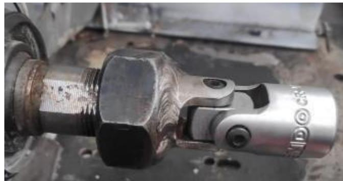
**Figura 55.** Se colocaron el cardan en la rosca de la transmisión
