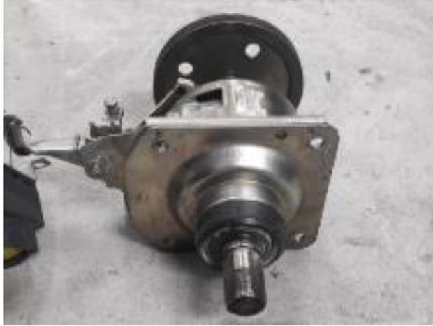
**Figura 39.** Transmisión cortada el eje de bajas revoluciones que se utiliza para lavar, para aprovechar la segunda velocidad del centrifugado y la rosca donde va el cardan.
