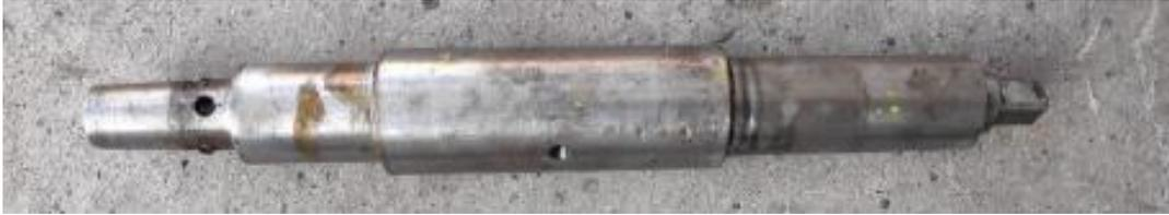
**Figura 47.** Eje de 16 milímetros con punta en cono truncado de 2.7565 grados
