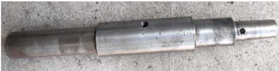
**Figura 46.** Eje mandril 31 milímetros con eje truncado a 2.65 grados.
