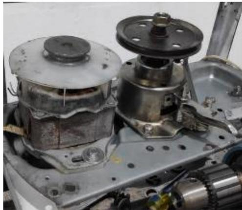
**Figura 50.** Ensamble de los dos motores y la transmisión en la base de montaje
