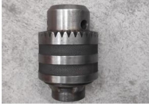
**Figura 45.** Mandril de taladro de 21 mm para sujetar la probeta.
