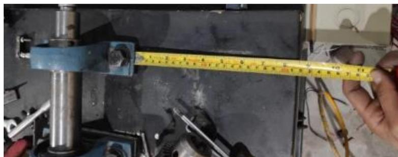
**Figura 53.** Se verifico que las chumaceras se encuentren simétricas con ayuda de un flexómetro con respecto a la mesa de trabajo
