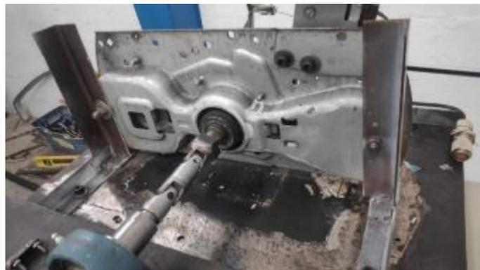
**Figura 56.** Se aseguro la base de montaje con la estructura rígida para evitar vibraciones y unir el cardan y fijar que este entre por completo entre la unión macho y hembra.
