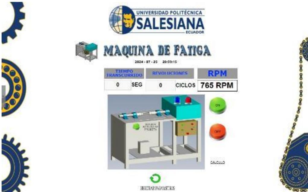
En la interfaz podemos observar el tiempo transcurrido desde que inicia el ensayo hasta que finaliza, el número de ciclos que ha dado la probeta antes de su fractura, los rpm del motor en funcionamiento, hora y fecha actuales, botones de encendido y apagado ya que la maquina cuenta con una automatización mediante un PLC que nos permite dar inicio o finalizar un ensayo directamente en la interfaz, también se lo puede hacer de manera manual al accionar los interruptores antes mencionados.
