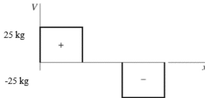
**Figura 25.** Diagrama de esfuerzo cortante con apoyos simples y cargas idénticas [18].
