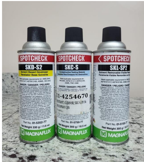
Figura 9 Kit de líquidos penetrantes de la marca Magnaflux.
