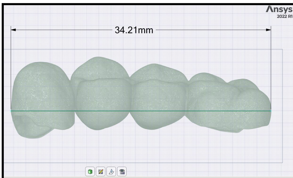
Figura 9 – Puente dental con medida y tratamiento superficial final para el proceso de análisis. Fuente Autor
