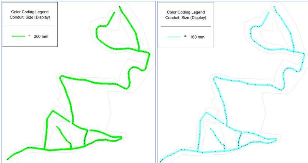
*Nota: A la izquierda la modelación del diseño original, derecha diseño de la variante del proyecto*
