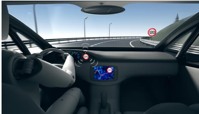
Figura 8. Asistente inteligente de velocidad.
