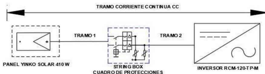
Figura 12. División de tramos en el lado CC de la planta fotovoltaica
