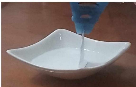
Fig 4. Prueba de Capilaridad
