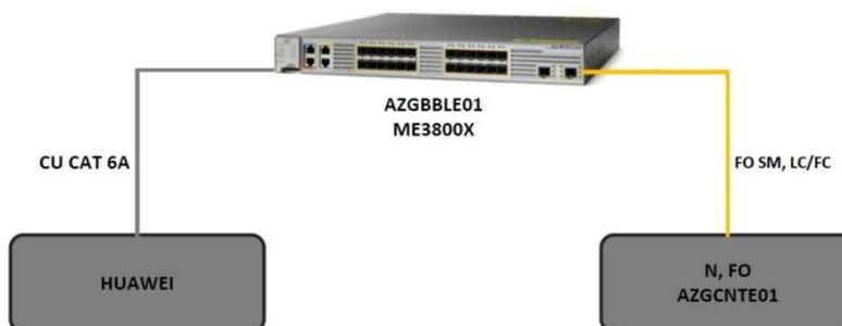
Figura 112: Diagrama de Conexión del Cableado Estructurado del nodo de Biblián
