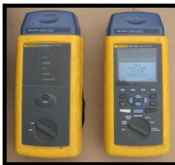
Figura 57: Sistemas De Certificación de Cable UTP
