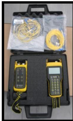
Figura 56: Sistemas De Certificación de Fibra Óptica
