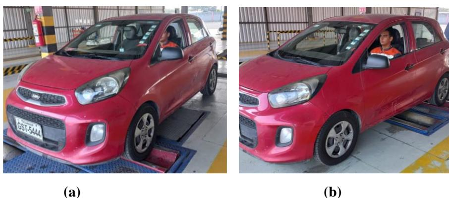
**Figura 1.** a) Medición del peso del vehículo en el eje delantero; b) Medición del peso del vehículo en el eje trasero.
