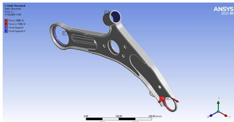
**Figura 7.** Condiciones de frontera.
