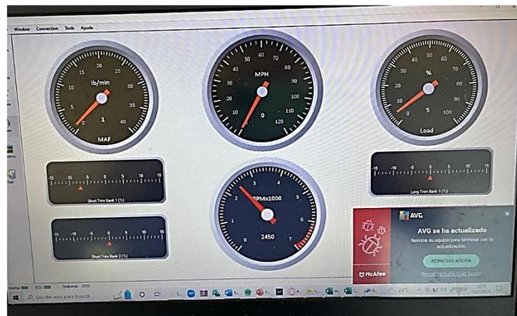
**Fig. 16.** Toma de datos (aceleración normal 2500 r.p.m.) interfaz del software OBDwiz
