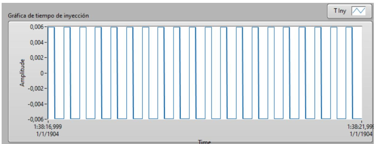
**Fig. 32.** Curva simulada en aceleración leve en LabVIEW tercera muestra a 1500 r.p.m.
