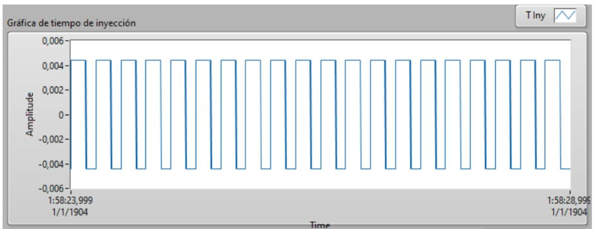
**Fig. 34.** Curva simulada en aceleración normal en LabVIEW tercera muestra a 2500 r.p.m.
