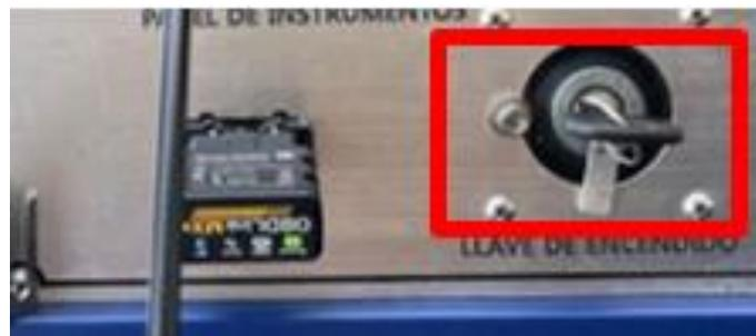
**Fig. 4.** Llave puesta en encendido (sin arrancar el motor)
