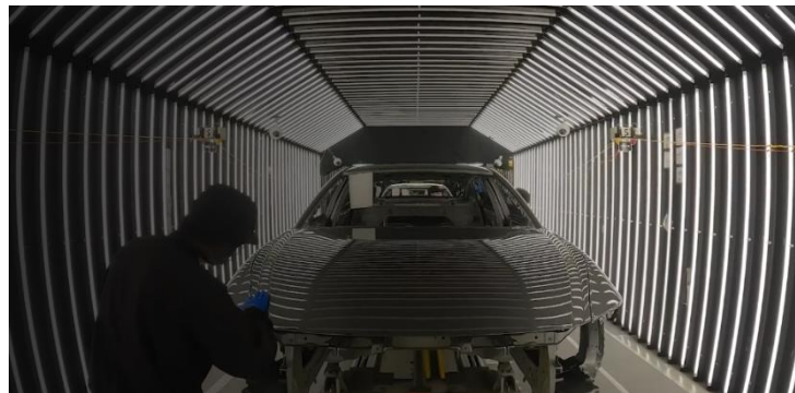
Figura 11: Inspección final (Toyota Global, 2023).
