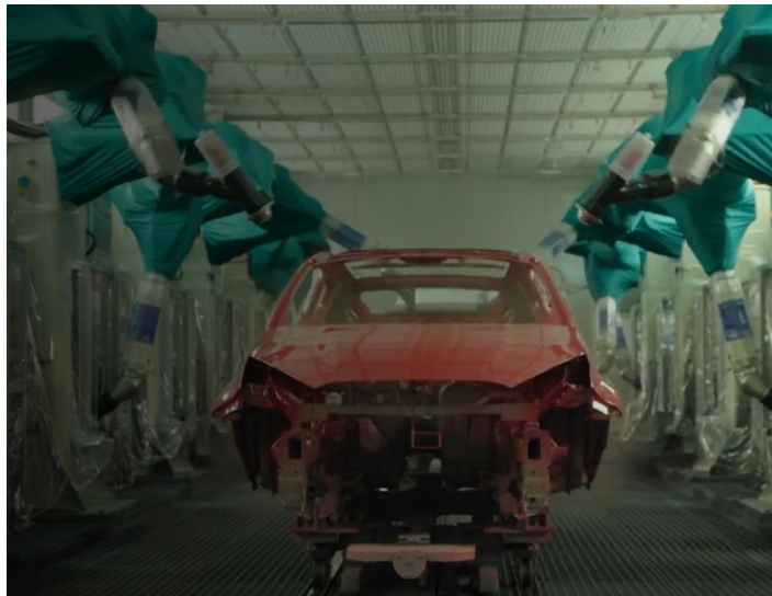
Figura 9: Capa superior pintura final (Toyota Global, 2023).
