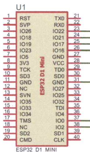
Figura 5: Esquemático ESP32 D1 MINI. Fuente: autores
