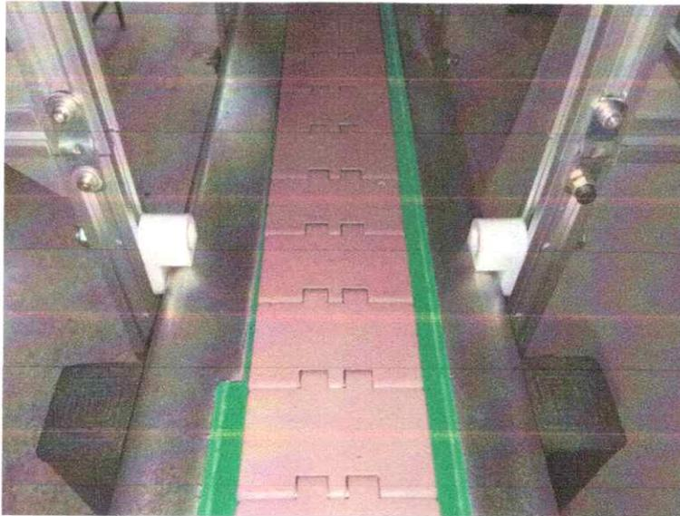
Figura 52. Soportes utilizados para sujeción del bastidor y la banda, "Tope". Fuente: Autores
