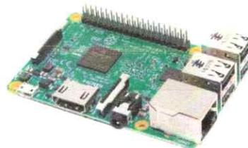
Figura 5. Tarjeta Raspberry Pi, ejemplo de sistema embebido [14]
