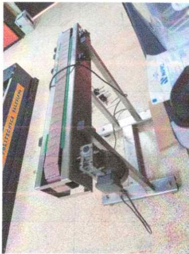
Figura 63. Vista lateral de la banda. Fuente: Autores
