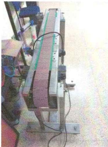
Figura 61. Banda transportadora a utilizar. Fuente: Autores
