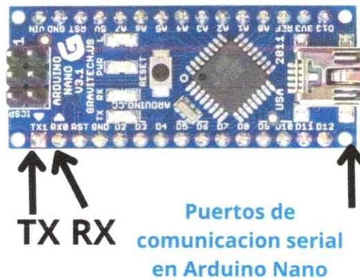
Figura 33. Puertos de comunicación serial en Arduino NANO. Fuente: Autores
