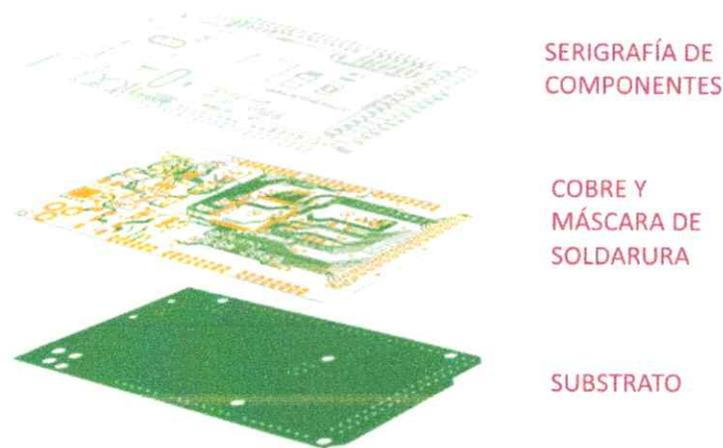
Figura 21. Partes de un circuito impreso en placa [47]
