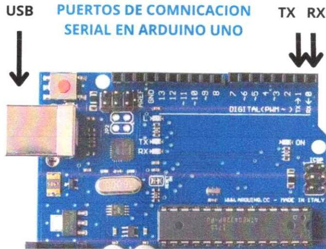
Figura 34. Puertos de comunicacion serial en Arduino UNO. Fuente: Autores
